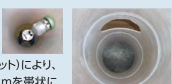
④ 試験体の本管部両端と岐管端部にエアーパッカーでの密閉後、管内に圧力(0.05MPa)をかけた上で、3分間保持していることを確認した。
