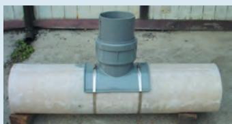
③ 切除処理した試験体にFRP工法一体型補修の施工を行い、気密試験用試験体とする。
