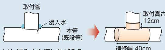
副材(水膨潤ゴム)の使用により、浸入水を流しながらの施工で外水圧試験で0.08MPaをクリアしている。
